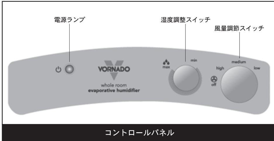
1. 風量調節スイッチが off になっていることを確認のうえ、電源コードをコンセントに差し込んでください。
